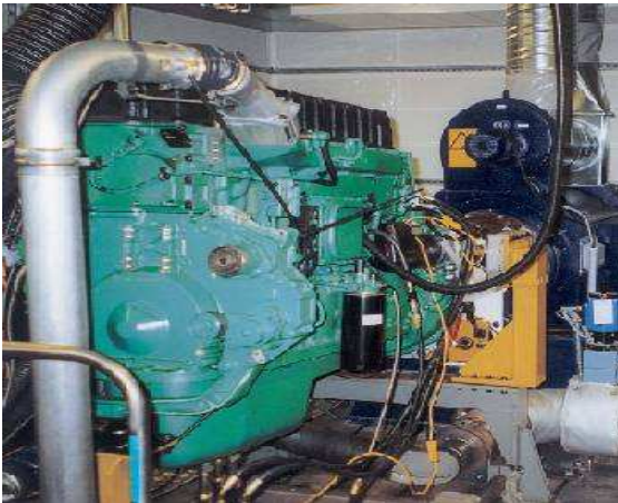
Obr. 1 Měření samotného motoru na výkonovém dynamometru
