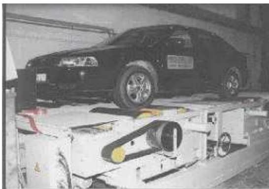
Obr. 2 Měření silničního vozidla na válcovém dynamometru [ www.dieselnet.com ]
