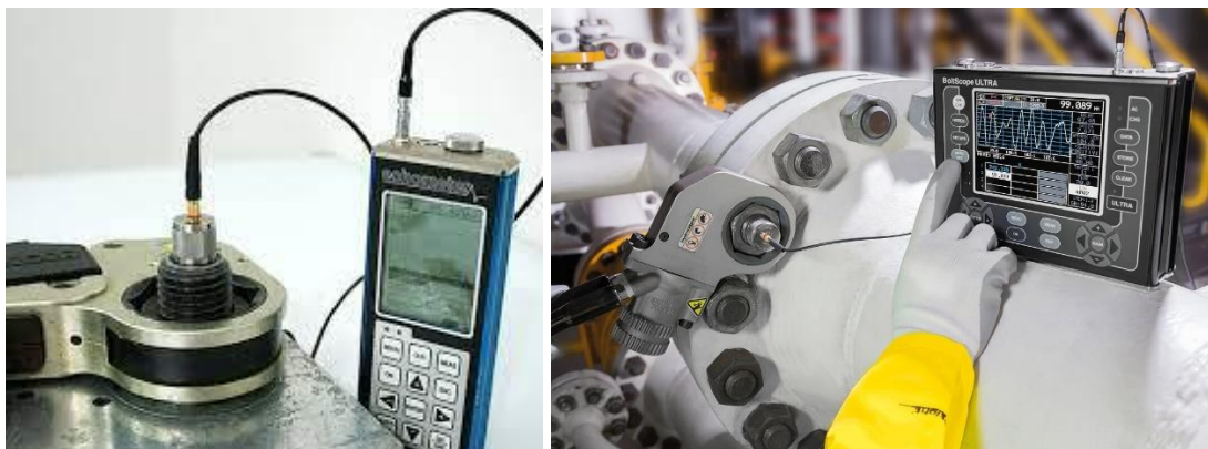
Obr. 6 Přístroje pro ultrazvukové měření prodloužení šroubů (Zdroj: [6],[7])
